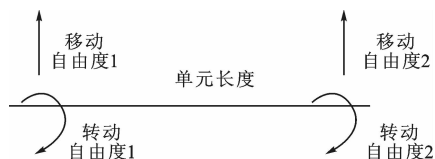
图4 转子任意一个单元的位移及角位移自由度情况
